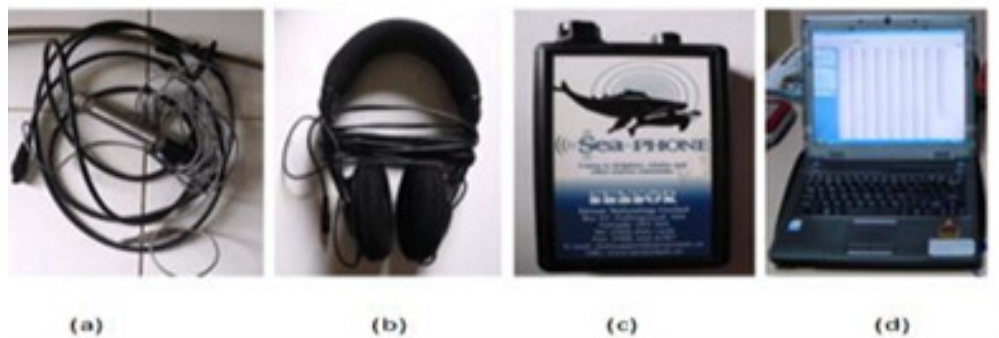
Gambar 2. Satu set alat perekam suara, (a) Hidrophone , (b) Headphone , (c) catu daya/baterai, dan (d) laptop untuk data logging dan data processing
